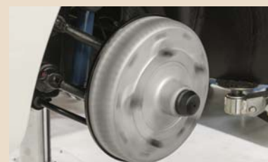
Tambor de travão rotativo - simulação de condução
