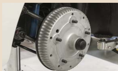
Sistema de travões completo, incluindo: calço de travão e tambor de travão
