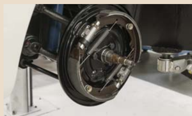
Calços de travão instalados no veículo
