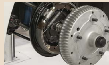
Instalação do tambor de travão
